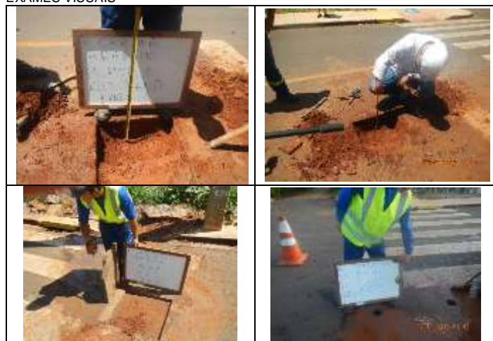
Registros dos ensaios das medições da espessura da camada de base por meio de ensaio destrutivo (abertura de placa de 50 cm x 50 cm) com identificação da espessura por meio visual.
